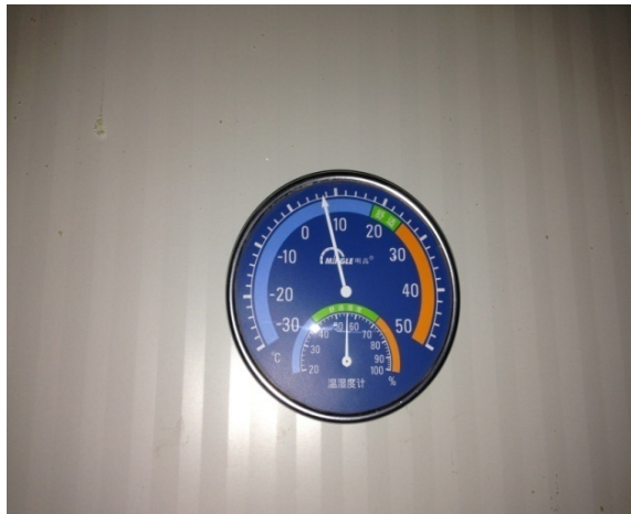
図 3-9 柏物産食品の冷蔵庫内の温度・湿度計
