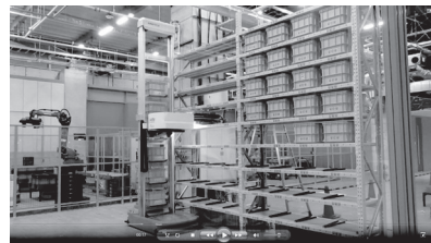
写真24 ACRが届けたコンテナからAPRが小物をピッキング
