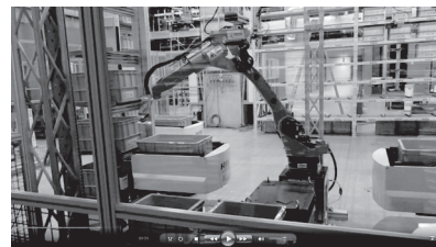
写真24 ACRが届けたコンテナからAPRが小物をピッキング
