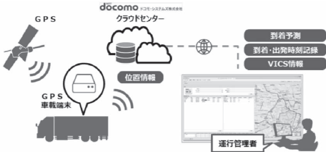
図7 GPSの位置情報をもとに輸配送の進捗管理を行うサービス [7]
